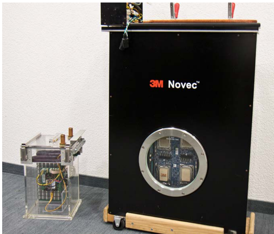
Der Prototyp für ein neues Kühlsystem. Die Server werden in eine spezielle Flüssigkeit getaucht. PHOTO: CLAUDIO BRENTINI
